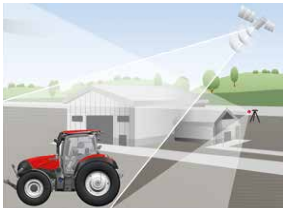
xFill overbrugt RTK+ signaalverliezen van maximaal 20 minuten
