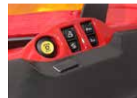
Aan de voor- en achterkant van de tractor zijn externe bedieningselementen aangebracht, voor het hydraulisch systeem, de aftakas en een extra besturingseenheid.
