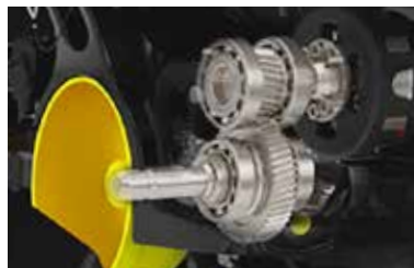
Directe vermogensoverdracht van motor naar frontaftakas.
