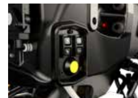
Aan de voor- en achterkant van de tractor zijn externe bedieningselementen aangebracht, voor het hydraulisch systeem, de aftakas en een extra besturingseenheid.
