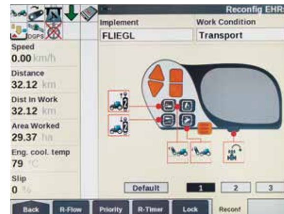
ISOBUS-functies kunnen op bestaande controllers worden geconfigureerd, zoals de Multicontroller, joystick en bedieningshendels.
