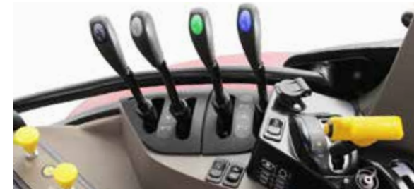
Modellen met zuiver mechanische regelventielen aan de achterkant beschikken bovendien over ergonomische hendels voor een eenvoudige bediening.
