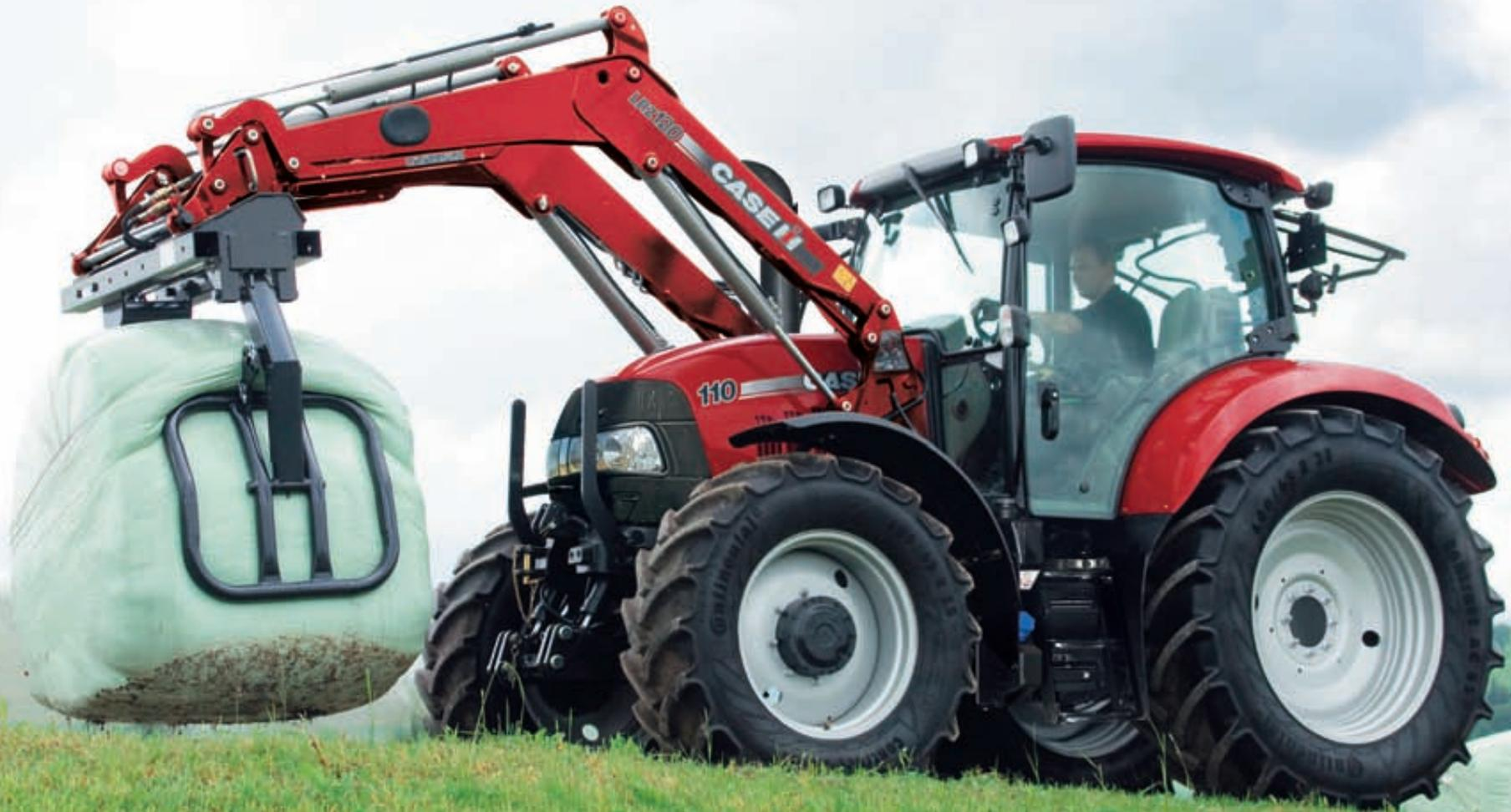
► **Het beste zicht.** Nieuwe, nivellerende 'Z'-kinematica in voorladerarm, afgedekte leidingen en modulair hydraulisch ventielenblok voor het beste zicht.
