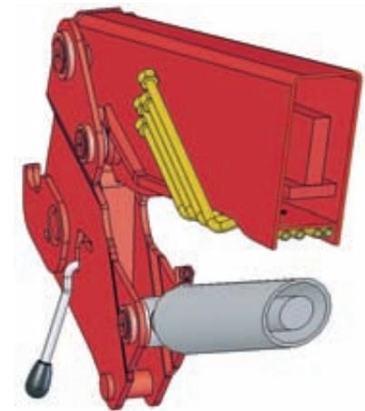
◀ **Een voorlader waarop u steeds kunt vertrouwen.** Alle voorladers zijn vervaardigd van fijnkorrelig staal van de hoogste kwaliteit. Fijnkorrelig staal geeft de voorlader enorm veel stabiliteit en stevigheid. Daarom gebruikt Case IH nog steeds fijnkorrelig staal voor de LRZ-serie. Het ontwerp van de hefarmen zorgt voor de grootste stevigheid, meer bepaald door de overlappende zone met een bijkomend dik, op flenzen gelijkend deel te versterken.
